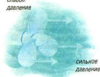
Когда лопасти отбрасывают воду, лодка приходит в движение.
