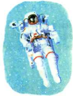
Космическое кресло перемещается благодаря выбросу сжатого воздуха.
