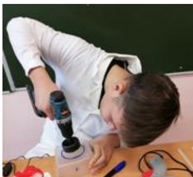
В крышке контейнера вырезаем одно отверстие радиусом 1,5 см для крепления насадки
